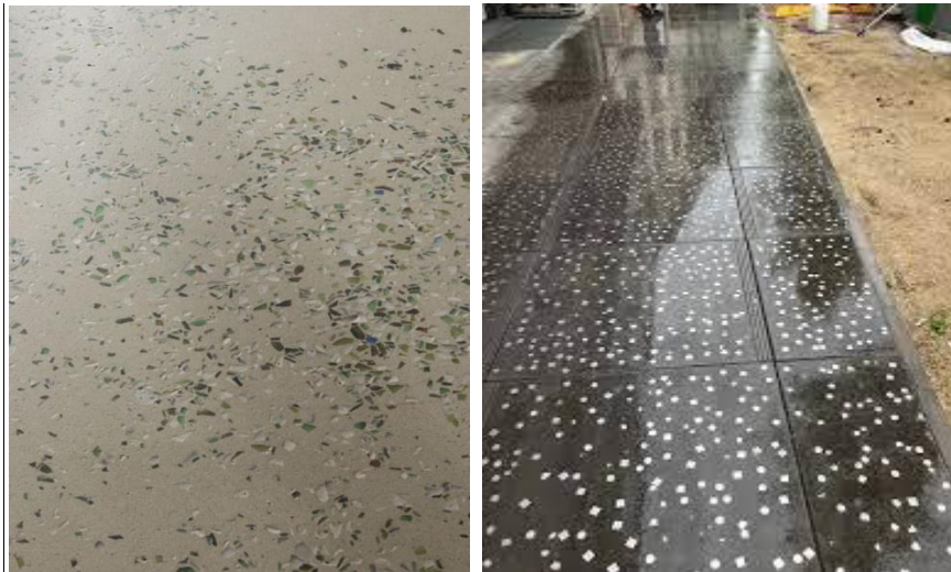
Figure 1.11 : Verre recyclé (la poudre et agrégats) dans le béton non structural [41].
