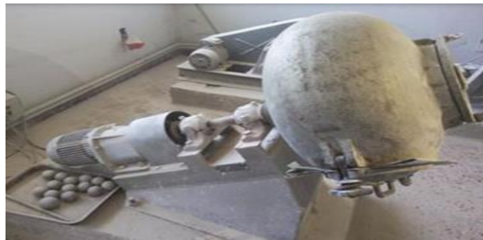
Figure 2.2: Broyage des déchets de verre.
