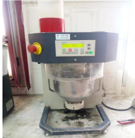
Figure 2.3 : Malaxeur pour la préparation du mortier normalisé
