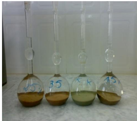
Figure 2.6: Masse volumique absolue des ciments.
