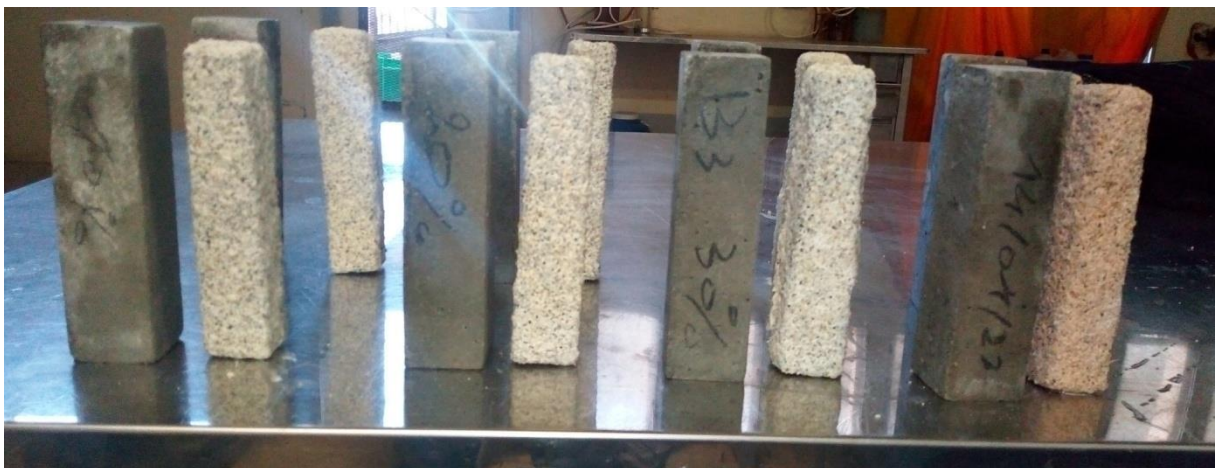
Figure 2.13 : Eprouvettes confectionnées et conservées dans l'acide sulfurique H_2SO_4 (5%) et l'eau potable à l'âge de 35 jours.
