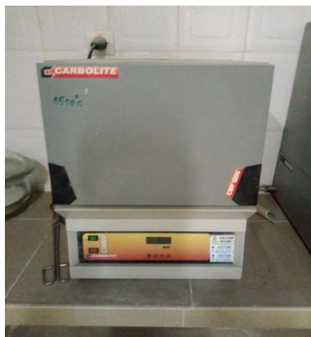
Figure 2.4 : Four de calcination pour PAF
