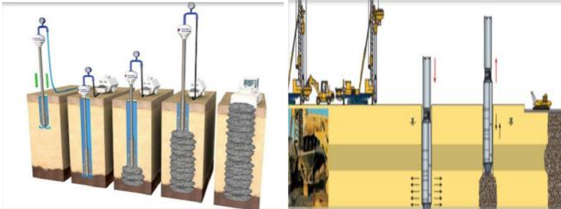
Figure I.4 Réalisation des colonnes ballastées (en voie humide et sèche) [12]
