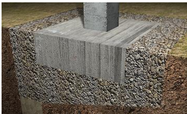
Figure II.12 Remblai de grave sous fondation
