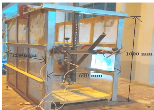
Figure IV.6 Le caisson du mur en modèle réduit
