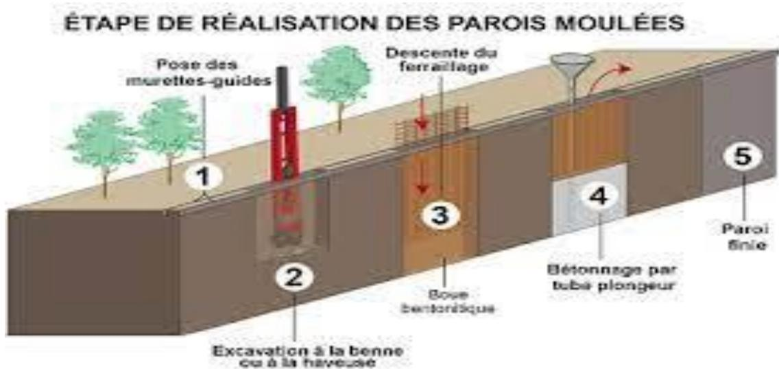
Figure I.19 : Principe général d'exécution d'une paroi moulé
