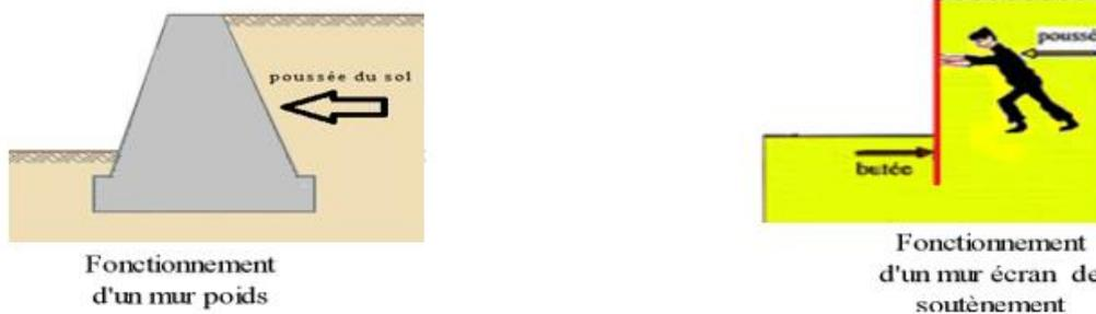
**Figure I.4: différence de fonctionnement entre un mur poids et un écran de soutènement**
