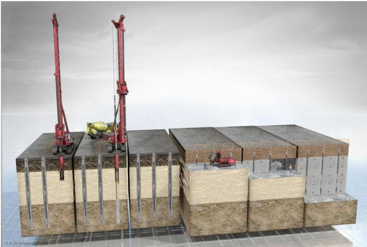
Figure I.11 : Schéma de la procédure d'exécution de la paroi berlinoise
