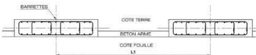
Figure I.17 : schéma d'une paroi Moscovite [8]
