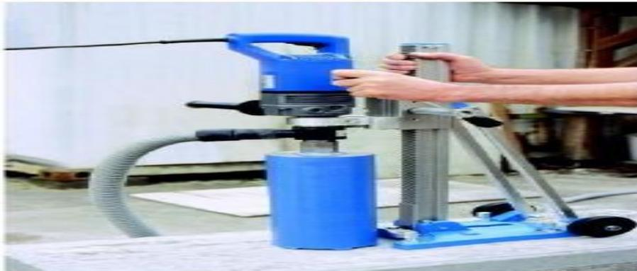
**Figure II.14** : Instrument de carottage.
