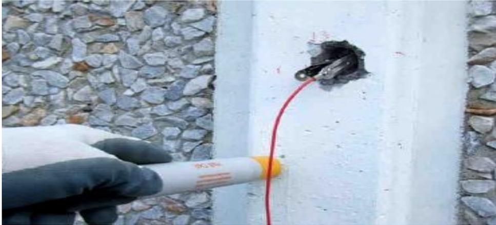
**Figure II.17 :** Mesure du potentiel de corrosion.
