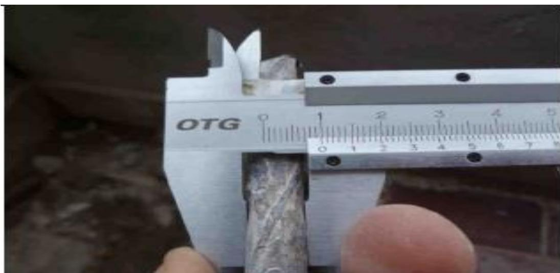
**Figure II.15** : Prélèvement d'aciers.
