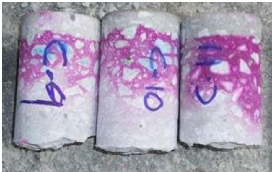
**Figure IV.3 :** Les essais de carbonatation.
