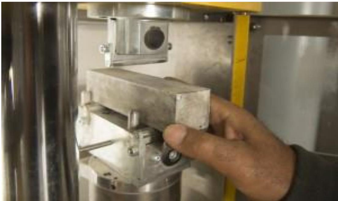
**Figure IV.4 :** Essai de flexion sur ciment.
