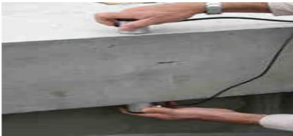
**Figure II.9** : Mesure ultrasonique.
