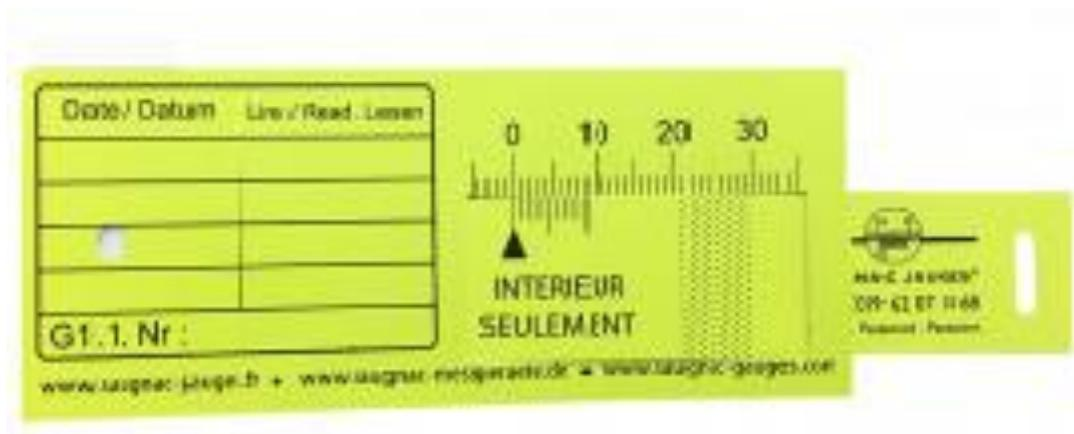
**Figure II.4** : Fissuromètre.
