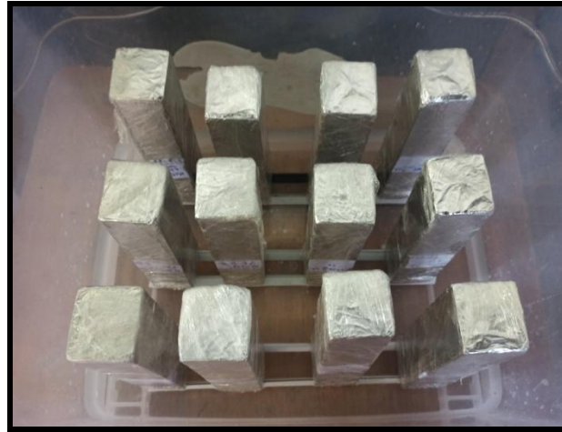
Figure II.17. Dispositif essai de capillarité.
