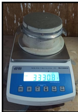
Figure II.12. La masse volumique à l'état frais.
