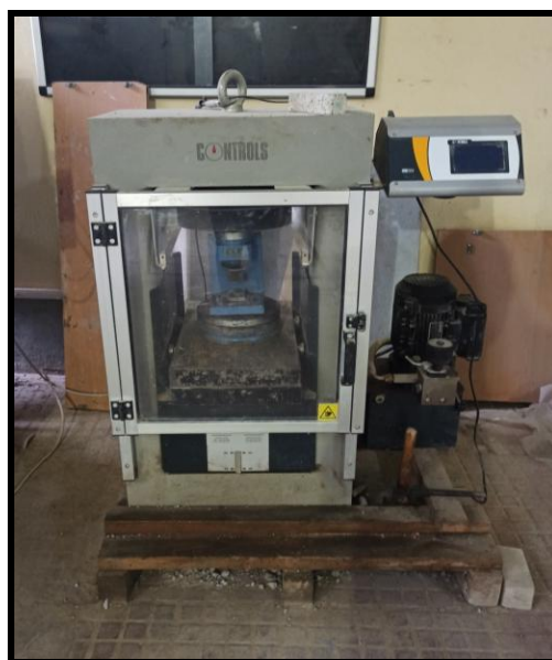
Figure II.16. L'essai de compression a l'état durci.
