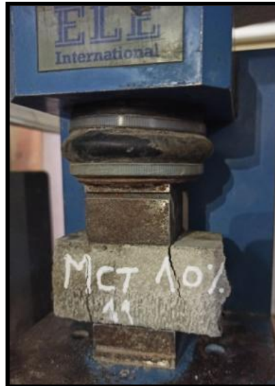
Figure III.8. Essai résistance à la compression.
