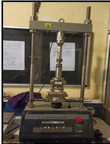
Figure II.15. L'essai de flexion a l'état durci.
