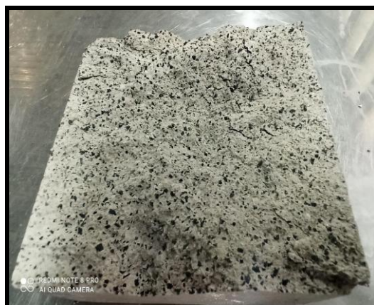
Figure III.2. Coupe d'une éprouvette (15x15x15) cm en mortier MC25%.
