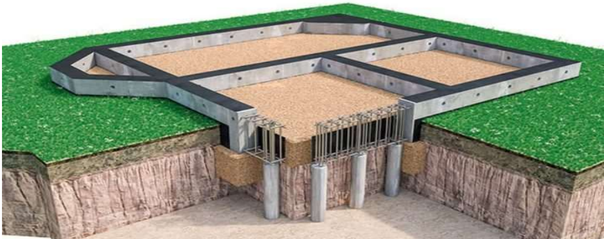
Figure I.2: fondation profonde sur pieu
