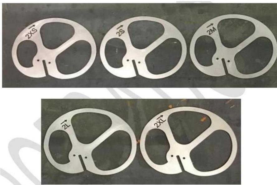
Fig.2.4 : Les cames en OxyGEN-IP
