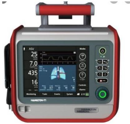
Fig.1.9 : HAMILTON-T1 Ventilateur USI de transport entièrement équipé pour les forces armées [10]
