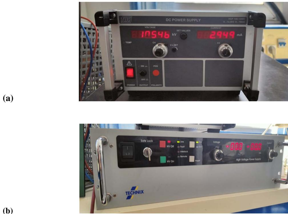
**Figure IV.3:** Photographies des générateurs de haute tension: (a) HT positive, (b) HT négative.
