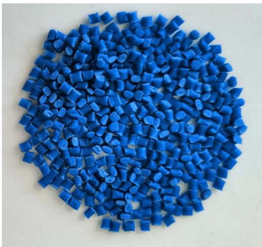
**Figure IV.14:** Aspect des granules de Polyamide (PA).
