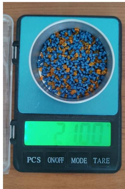
**Figure IV.9:** Balance électronique (Précision de 0,01g).
