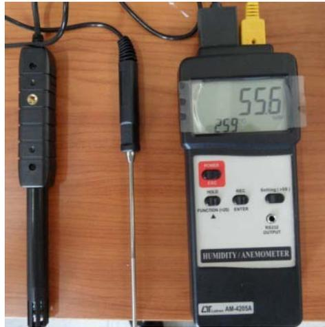
**Figure IV.8:** Photographie du thermo-hygromètre numérique (Modèle Lutron AM-4205A).
