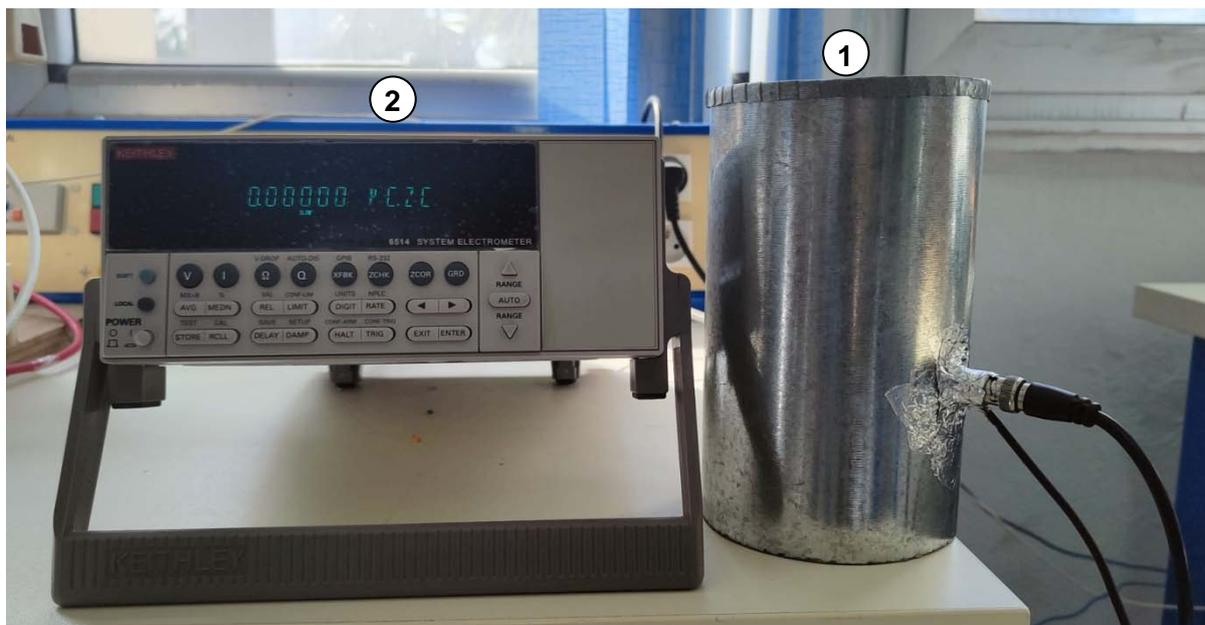
**Figure IV.11:** Photographie du montage de mesure de la charge électrique: (1) Seau de Faraday, (2) Electromètre numérique (Keithley - modèle: 6514).
