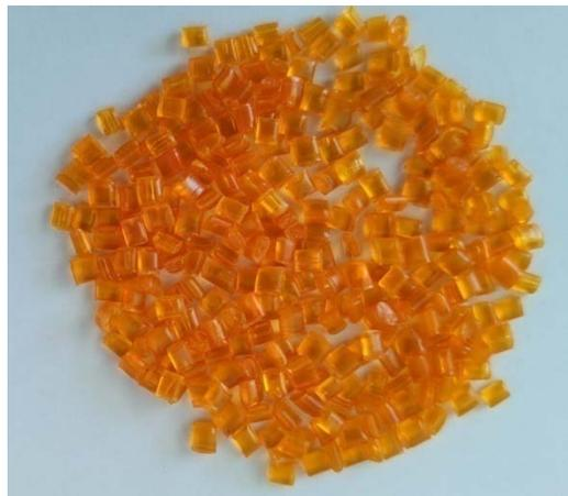
**Figure IV.13:** Aspect des granules de Polycarbonate (PC).
