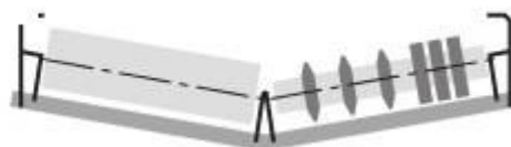
Figure II.6.b 2 rouleaux ordinaires ou amortisseurs de bagues caoutchouc
