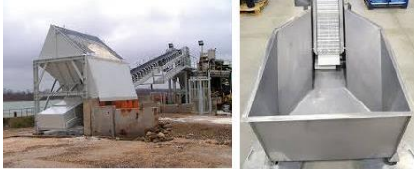
Figure I.11 Vues de trémie de chargement.
