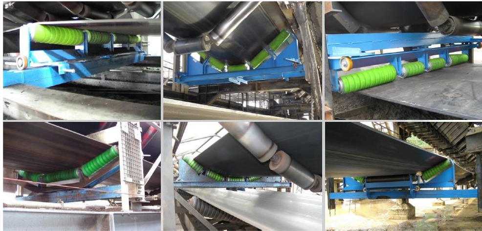
Figure I.23 Fixation des rouleaux sur la station-support
