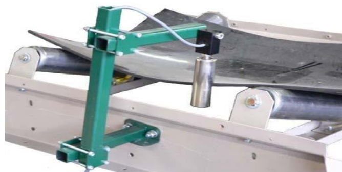
Figure III.8 Surveillance du désalignement de la bande.
