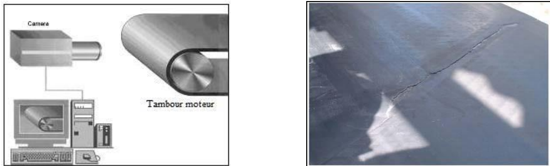
Figure III.2 Surveillance de la surface extérieure de la bande.
