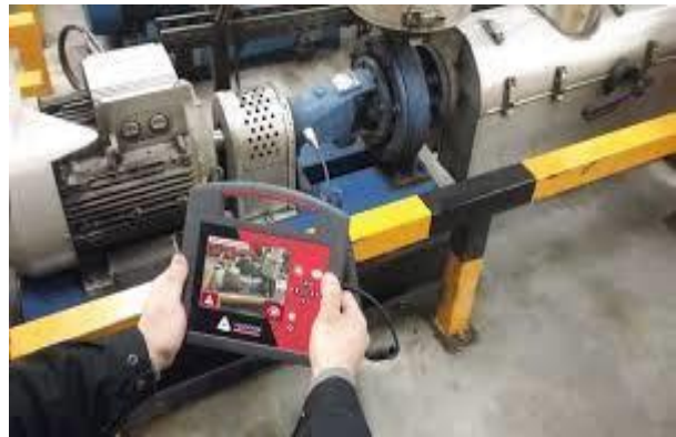
Figure III.6 Détection des défauts par l'analyse vibratoire.
