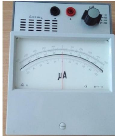
Figure II.4 : Microampèremètre à aiguille utilisé dans la mesure du courant de décharge
