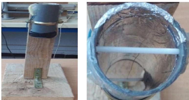
**Figure II.3:** Système de la décharge couronne en configuration fil-cylindre
