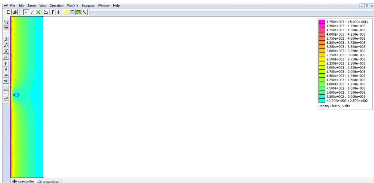
Figure III.22: Distribution spatiale du potentiel électrique pour la géométrie Fil-Cylindre avec particule
