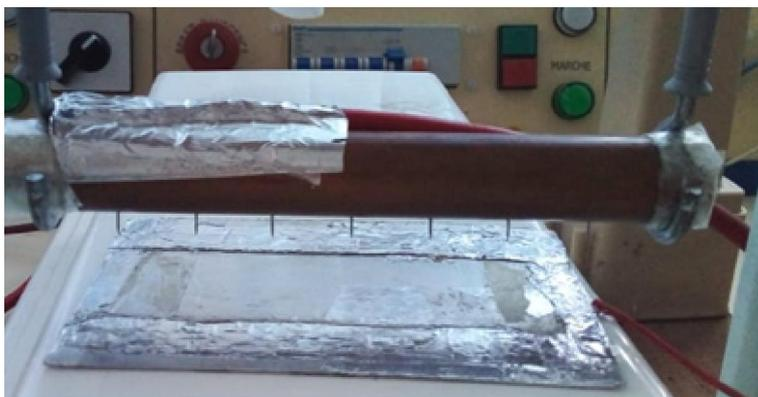
**Figure II.2** : Système de décharge couronne en configuration multipointes/plan
