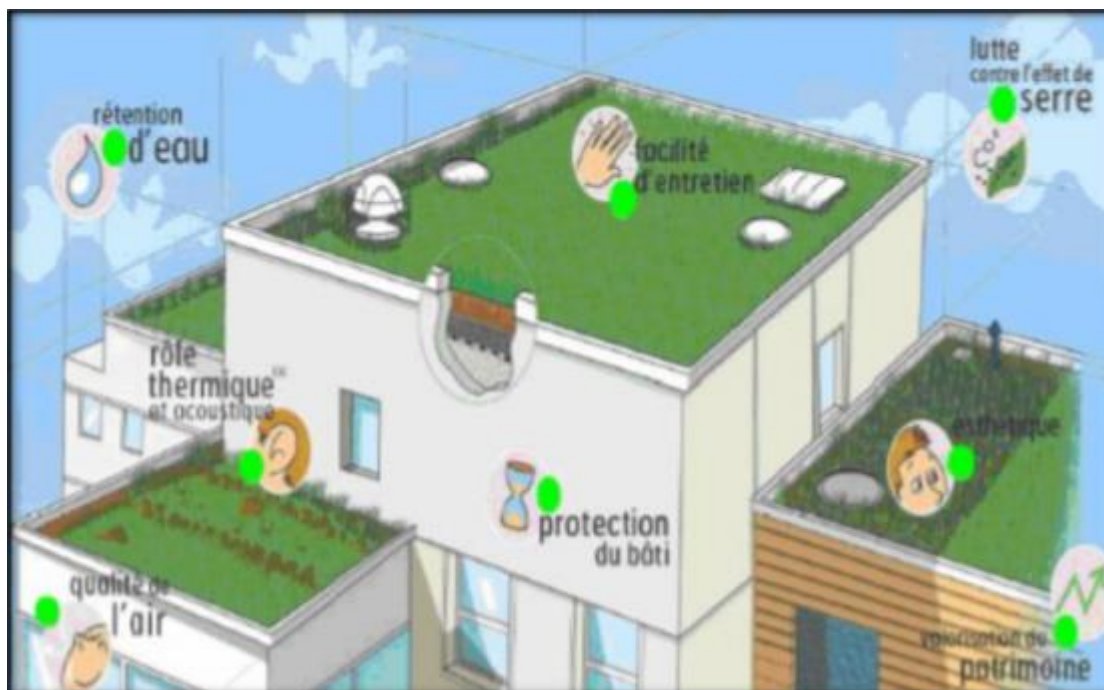
Figure 53: Toiture-terrasse végétalisée extensive à Andrésy (p78).
