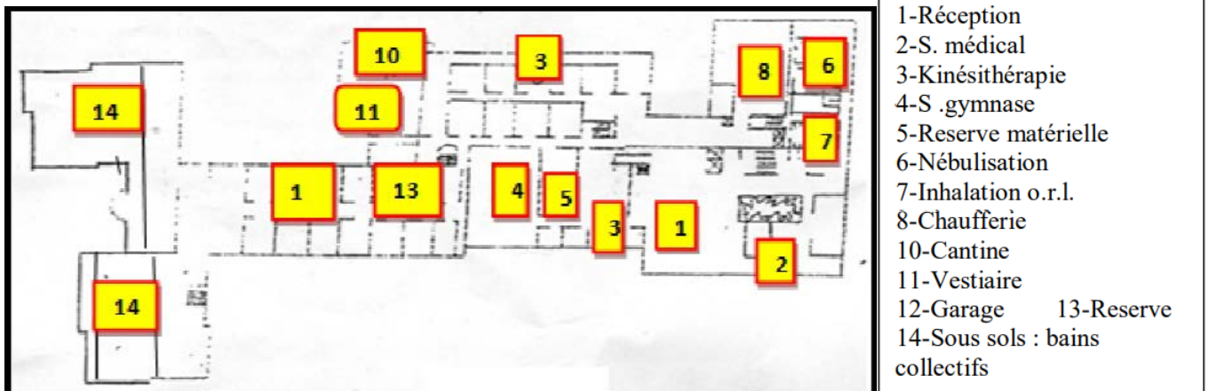
Figure 115:plan RDC du bloc thermal.
