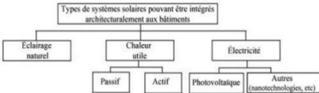
Figure 01 : Types des systèmes solaires classés selon différents besoins pour le bâtiment. Source : www.guidebatimentdurable.brussels
