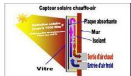
Figure 11 : Schéma représentant le fonctionnement du capteur solaire à air.
