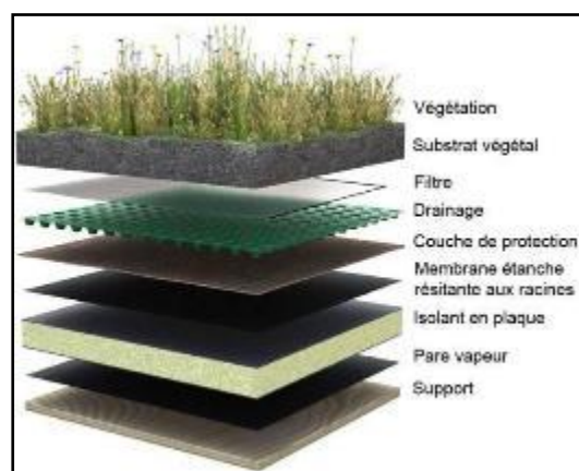
Figure 131 : structure d'un toit jardin
