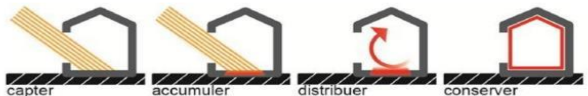
Figure 05 : Représentation schématique des quatre principes du chauffage solaire
