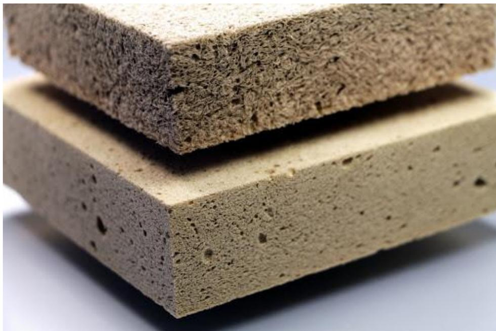
Figure 33 Béton biosourcé, source : [www.infociments.fr](http://www.infociments.fr)
