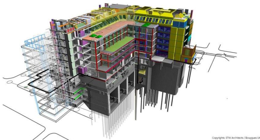
Figure 42 Illustration d'une modélisation 3D d'un bâtiment à l'aide d'un logiciel de CAO, source : [www.wsp.com](http://www.wsp.com)
