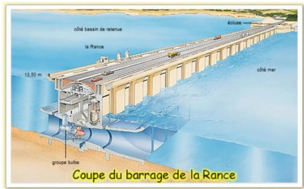
Figure 29 Illustration d'une coupe sur le barrage de la Rance, source : google image
