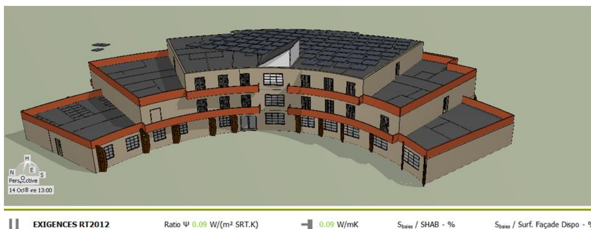
Figure 41 : L'indicateur Ratio \Psi de transmission thermique linéique
