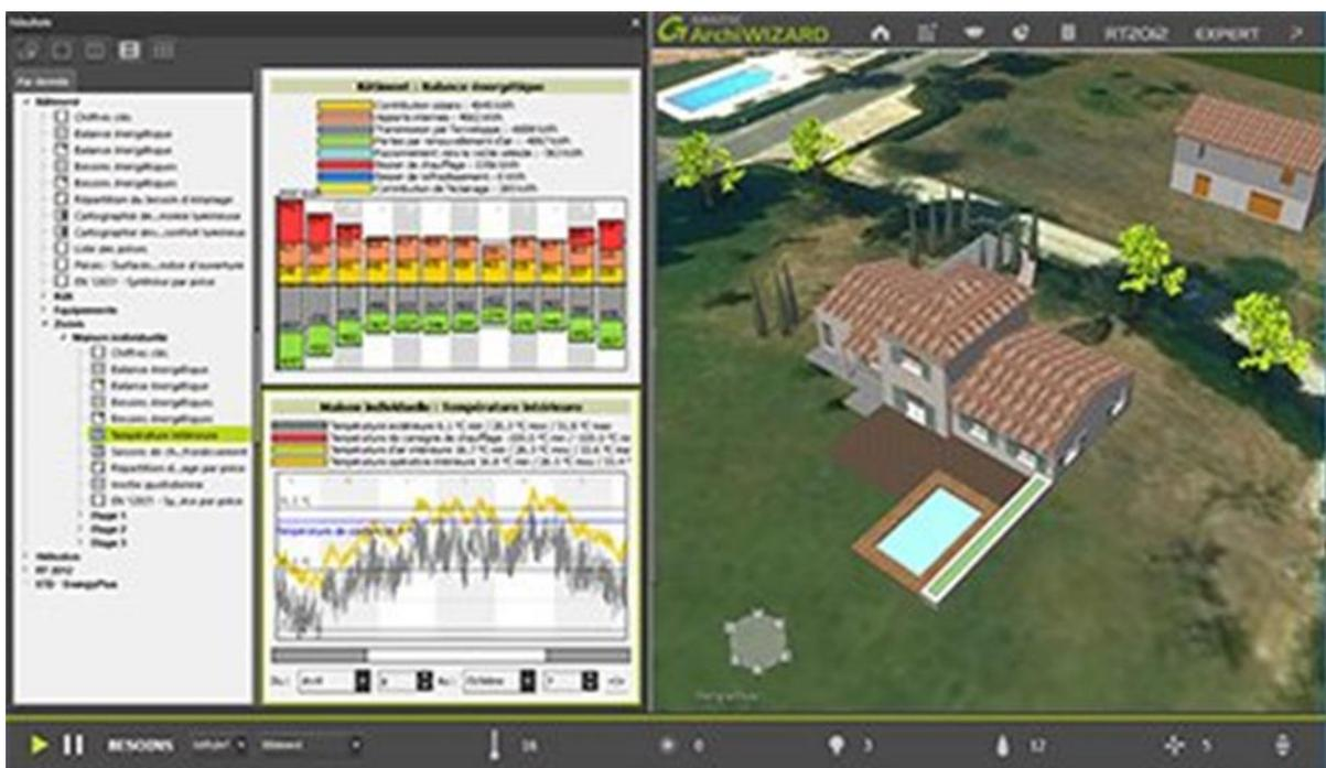
FIGURE 68 SIMULATION ENERGETIQUE PAR ARCHIWIZARD
