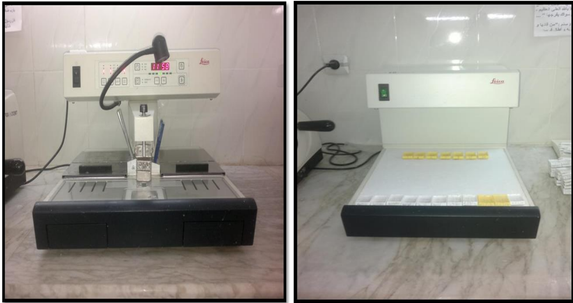
Photo 08 : Station d'enrobage (photo personnelle).
