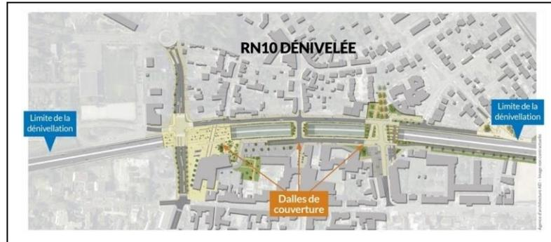
Figure 04. Dénivellation et couverture de la RN10
