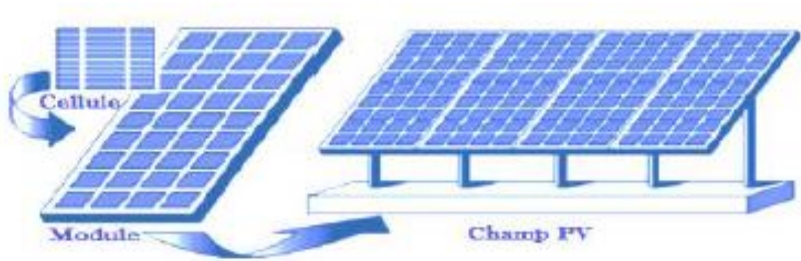
FIGURE I.7: Cellule au module au générateur photovoltaïque [7].
