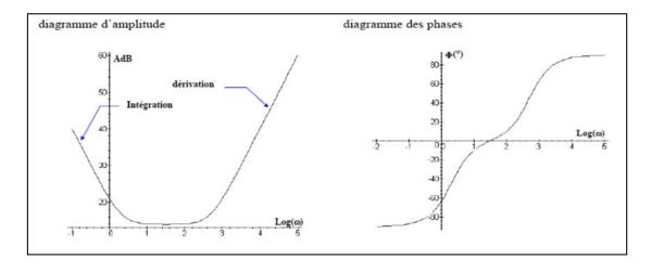
Fig. III.6 : Diagramme de Bode d'un PID
