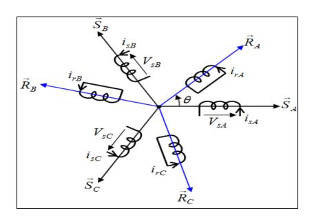
Fig. I. 9 : Représentation des enroulements de la machine dans l'espace électrique.
