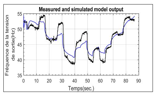
**Fig.II.14:** Comparaison des deux réponses en fréquence fournies par le système SEIG réel et le modèle linéaire correspondant
