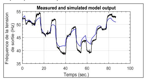
Fig.II.8: Comparaison entre la sortie du système réel et celle prédite par le modèle  $G_f(s)$
