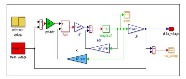
Fig. III.12 : Schéma bloc de la commande de l'amplitude de la tension de sortie
