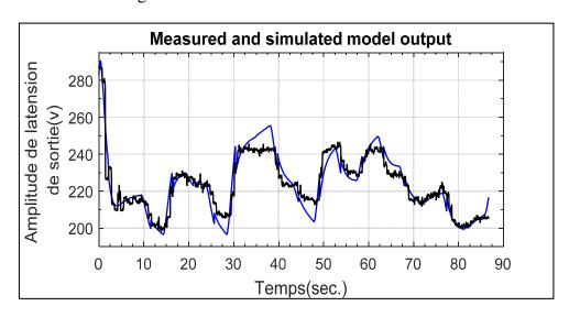
**Fig. II.1**:Comparaison des deux réponses en amplitude fournies par le système SEIG réel et le modèle linéaire correspondant
