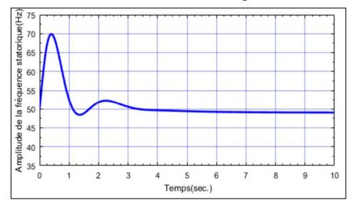
**Fig. IV.11.b** : Fréquence de la tension statorique de sortie contrôlée par la commande par retour d'état utilisant l'observateur de *Luenberger*
