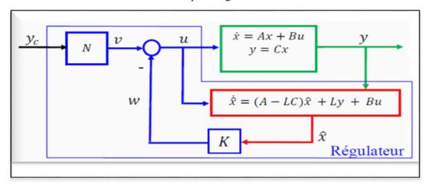
Fig. IV.7 : Commande par retour d'un système état reconstruit
