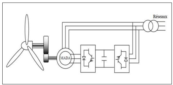
Fig. I.4 : Système éolienne connectés avec génératrice à rotor bobiné
