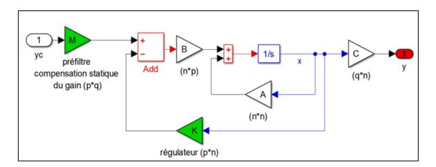
Fig. III.11: Commande par retour d'état « siso »
