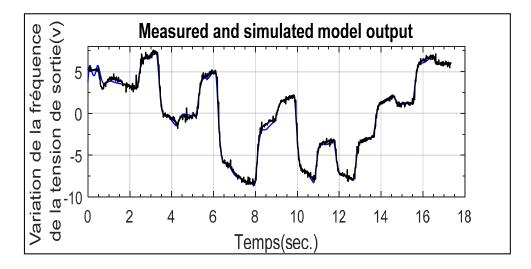
Fig.II.16: Comparaison des deux réponses en variation de fréquences fournies par le système réel et le modèle linéaire  $\delta G_f(s)$
