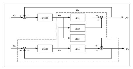
Fig. IV.16 : La boucle de commande basée sur le contrôleur décentralisé
