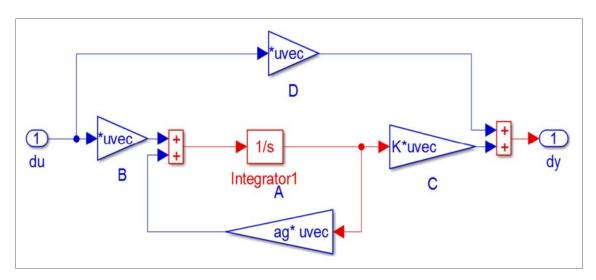
Fig. IV.1 : Schéma bloc de Simulink décrivant le modèle d'état du système SEIG
