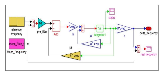
Fig. III.15: Schéma bloc de la commande de fréquence de la tension de sortie
