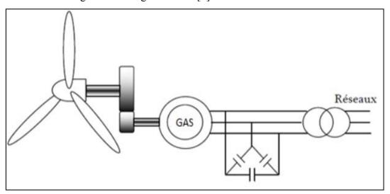
Fig. I.6 : Génératrice asynchrone à cage à vitesse fixe
