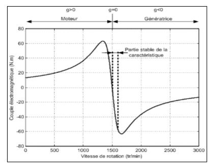
Fig. I.8 : Caractéristique couple/vitesse d'une machine asynchrone à 2 paires de pôles
