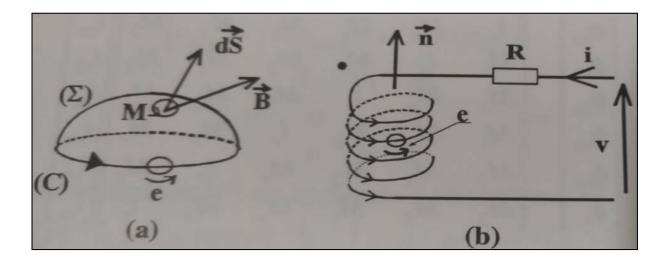
Fig I.10 :a-convension de signe de la loi de faraday et b-modèle d'une phase avec force électromotrice[8]
