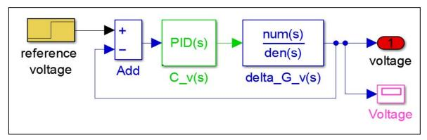
Fig. III.7 : Schéma bloc de réglage de l'amplitude de la tension de sortie par le contrôleur PID
