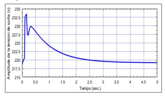
**Fig. IV.6.a** : Amplitude de la tension statorique de sortie contrôlée par la commande par retour d'état utilisant un observateur d'état standard
