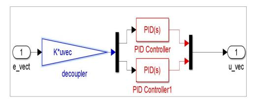
Fig. IV.18: Construction du régulateur PID décentralisé
