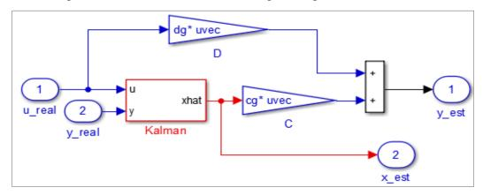
Fig. IV.12 : Estimation les états inaccessibles et les sorties du système SEIG en utilisant le filtre de *Kalman*
