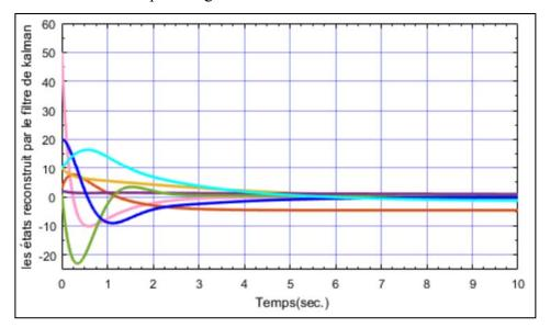
Fig. IV.14 : Estimation des états de SEIG par le filtre de Kalman
