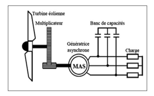
Fig. I.11 : Machine asynchrone connectée au réseau banc de capacité
