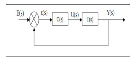
Fig. III.2: Schéma bloc d'un système bouclé corrigé
