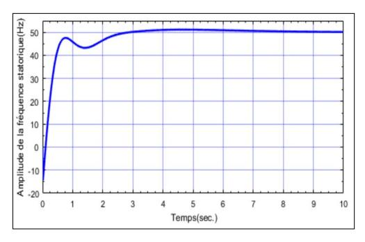
Fig. III.10 : La réponse en boucle fermée de fréquence statorique
