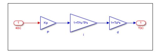
Fig. III.4: Régulateur PID structure série
