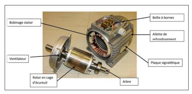
Fig. I.2 : Constituants de la machine asynchrone
