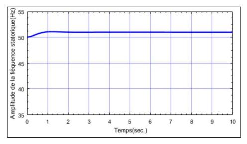
**Fig. IV.6.b** : Fréquence de la tension statorique de sortie contrôlée par la commande par retour d'état utilisant un observateur d'état standard
