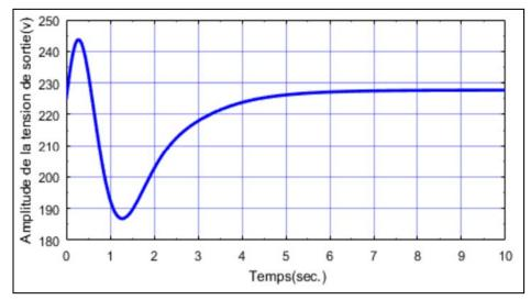
**Fig. IV.11.a**: Amplitude de la tension statorique de sortie contrôlée par la commande par retour d'état utilisant l'observateur de *Luenberger*
