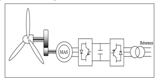
Fig. I.7 : Génératrice asynchrone à cage à vitesse variable
