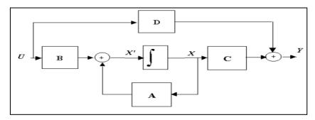
Fig. II.3 : Schéma fonctionnel de la représentation d'état
