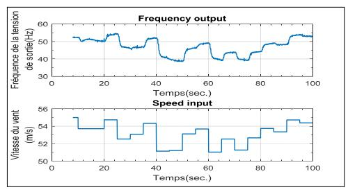
Fig. II.7 : La variation de la fréquence de la tension de sortie F en fonction de la vitesse du vent  $\omega$
