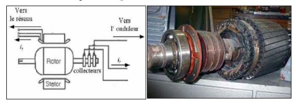
Fig. I.3: Machine à induction à rotor bobiné
