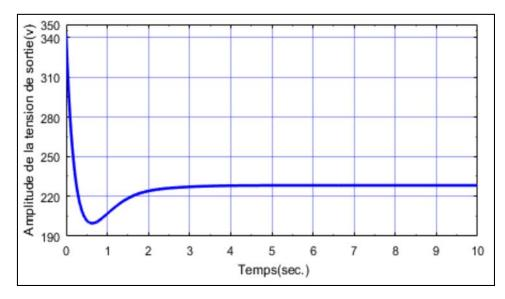
**Fig. IV.15.a** : Amplitude de la tension statorique de sortie contrôlée par la commande par retour d'état utilisant le filtre de *Kalman*
