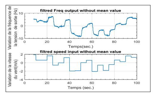
**Fig. II.11** : La variation de la fréquence de la tension de sortie  $\delta f$  et la vitesse du vent  $\delta \omega$
