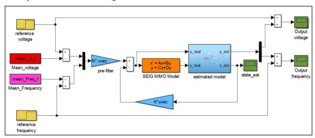
Fig. IV.9 : Schéma bloc de commande de SEIG basée sur l'observateur de Luenberger
