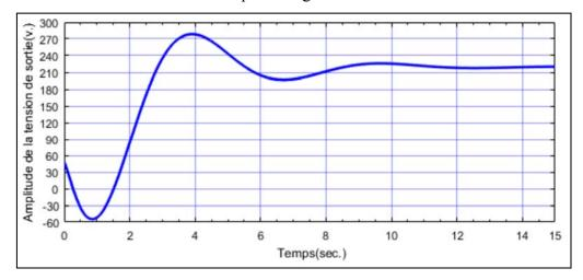
Fig. IV.19.a : Amplitude de la tension statorique de sortie contrôlée par le régulateur PID décentralisé
