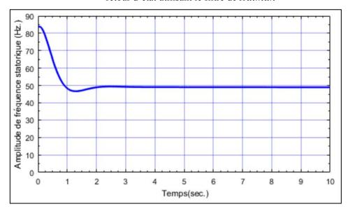
**Fig. IV.15.b** : Fréquence de la tension statorique de sortie contrôlée par la commande par retour d'état utilisant le filtre de *Kalman*
