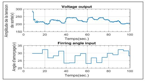
Fig. II.5 : La variation de l'amplitude de la tension de sortie v en fonction de  $\alpha$
