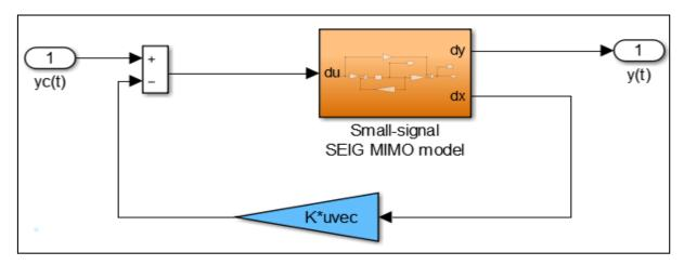
Fig. IV.2 : Implémentation de la loi de commande par retour d'état dans la boucle de commande
