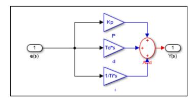
Fig. III.3 : Régulateur PID structure parallèle
