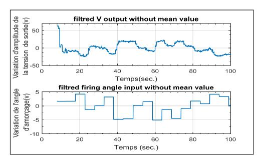
Fig. II.9: La variation de l'amplitude de la tension de sortie  $\delta v$  en fonction de l'angle d'amorçage  $\delta \alpha$
