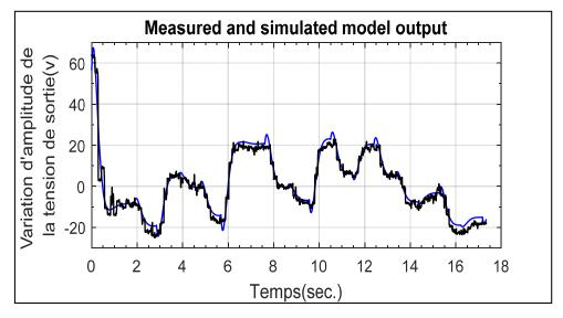
**Fig.II.15:** Comparaison des deux réponses en variation d'amplitudes fournies par le système réel et le modèle linéaire  $\delta G_{v}(s)$
