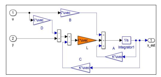
Fig. IV.8 : Schéma bloc de l'observateur de Luenberger
