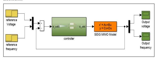
**Fig. IV.17**: Schéma bloc de la commande basée sur le régulateur PID décentralisé Sachant que la matrice de transfert qui décrit le régulateur PID décentralisé s'écrit par :
