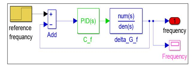
Fig. III.9 : Schéma bloc de réglage de la fréquence statorique par le régulateur PID
