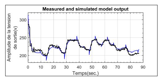
**Fig.II.6:** Comparaison entre la réponse du système réel et celle du modèle  $G_{\nu}(s)$
