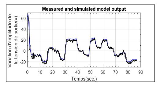
**Fig.II.10:** Comparaison entre la réponse du système réel et celle du modèle linéaire  $\delta G_{v}(s)$
