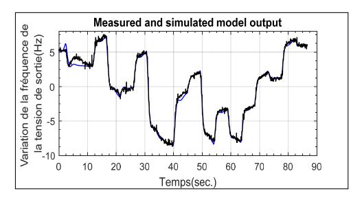
Fig.II.12: Comparaison de la sortie réelle et celle prédite par le modèle des faibles signaux  $\delta G_f(s)$
