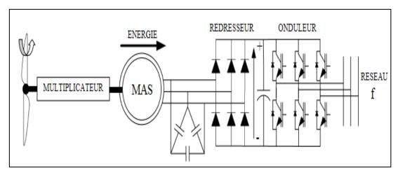
**Fig. I.1** : Machine asynchrone connectée sur le réseau par l'intermédiaire d'un ensemble redresseur – onduleur[3]
