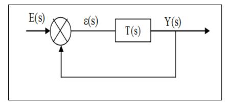
Fig. III.1 : Schéma bloc d'un système bouclé non corrigé
