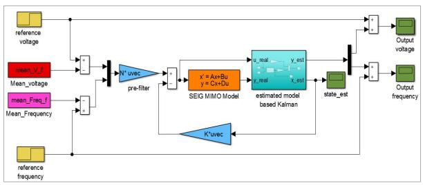
**Fig. IV.13** : Schéma bloc de commande de SEIG par retour d'état basée sur l'estimation par le filtre de *Kalman*
