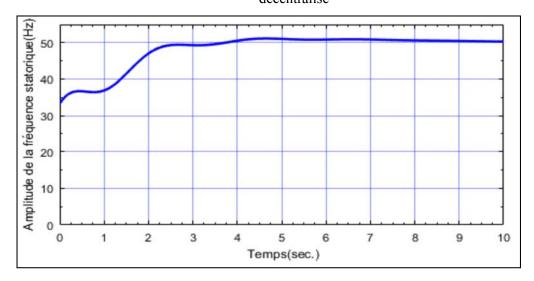
**Fig. IV.19.b** : Fréquence de la tension statorique de sortie contrôlée par le régulateur PID décentralisé
