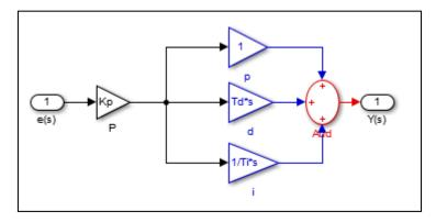
Fig.III.5: Régulateur PID structure mixte
