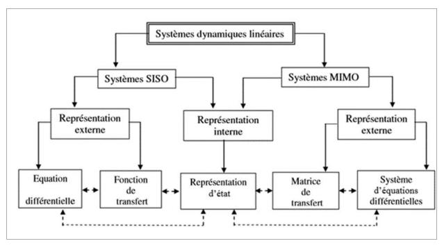
Fig. II.1 : Différents types de représentations des systèmes
