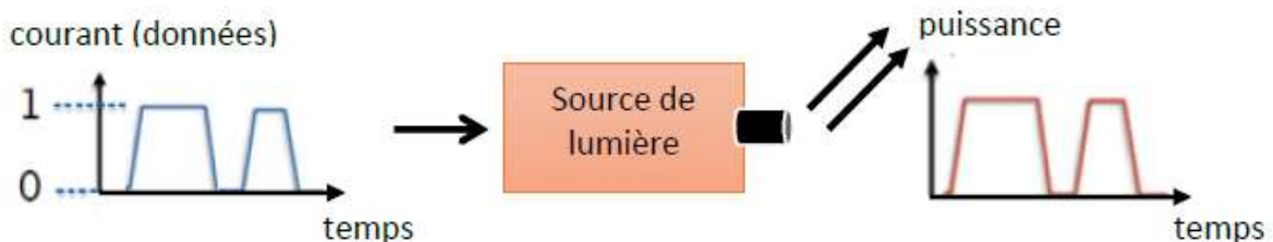
Figure.1.4 : Principe de base d'une modulation directe.
