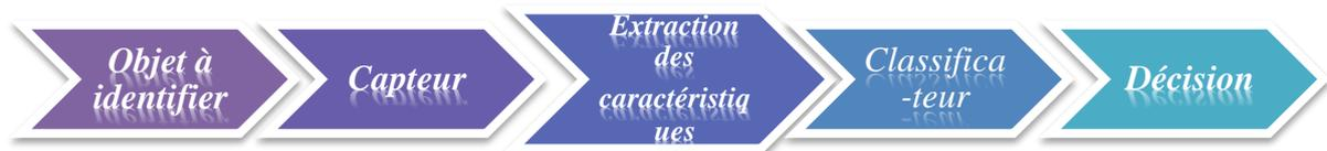
**Figure II.1 :** Schéma de base d'un processus de reconnaissance des formes.
