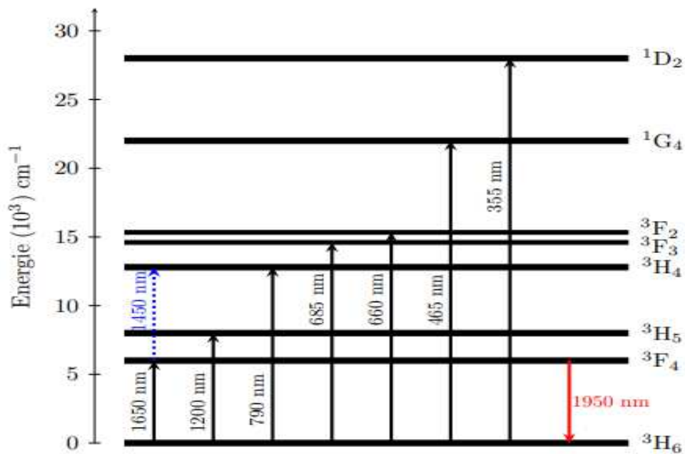
Figure II.2 : Diagramme d'énergie de l'ion thulium dans la silice [20]
