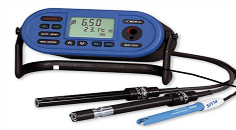
**Figure 18 :** le multi paramètre de type WTW 350i
