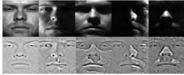
Figure III.7: Exemples d'images traitées : images originales (ligne supérieure), images traitées par DOG (ligne inférieure) [2]
