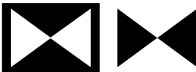
Figure (III.3) :Le conducteur métallique est indiqué en noir dans les schémas d'une antenne nœud papillon (à droite) et son équivalent en fente (à gauche).
