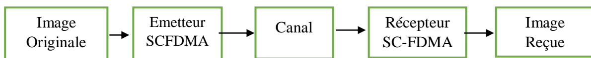
Figure III.1 : Les étapes de transmission d'une image numérique à l'intérieur d'un système SC-FDMA.
