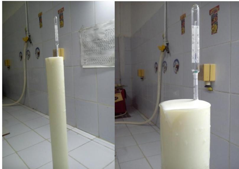
Figure 8 : mesure de la densité et la température par thermo lactodensimètre
