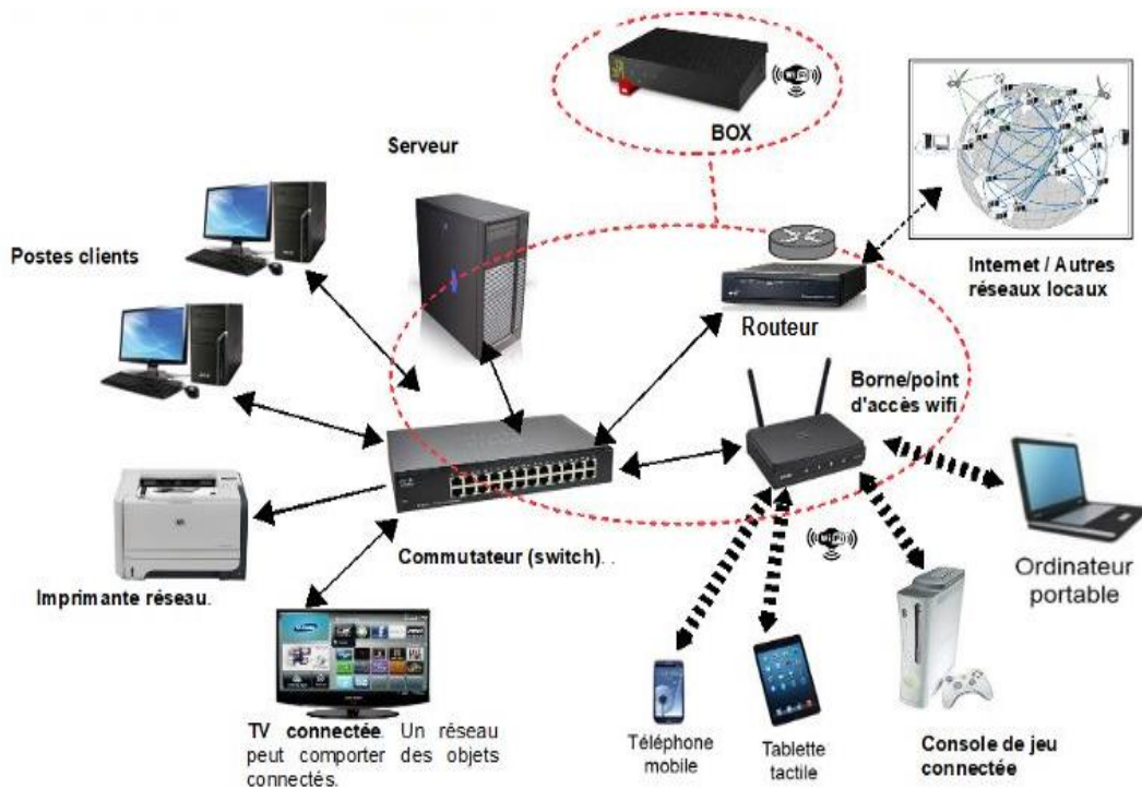
Figure I. 1 : Réseau informatique local et ses éléments.
