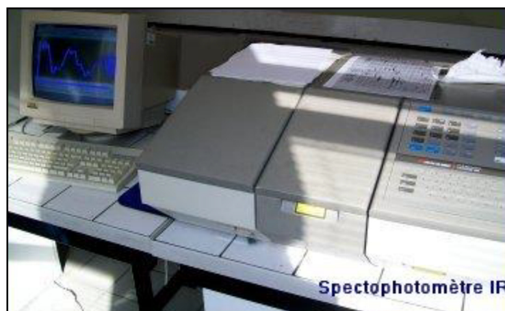
Figure III.6 Photographie du spectrophotomètre IRTF (Laboratoire LAIGM de l'université 08 Mai 1945-Guelma).
