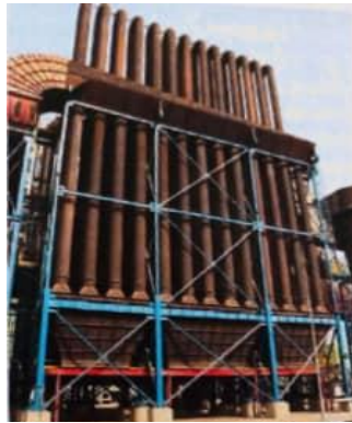
Figure 4 : FTP avec refroidisseur « en Épingle ».Source : auteur
