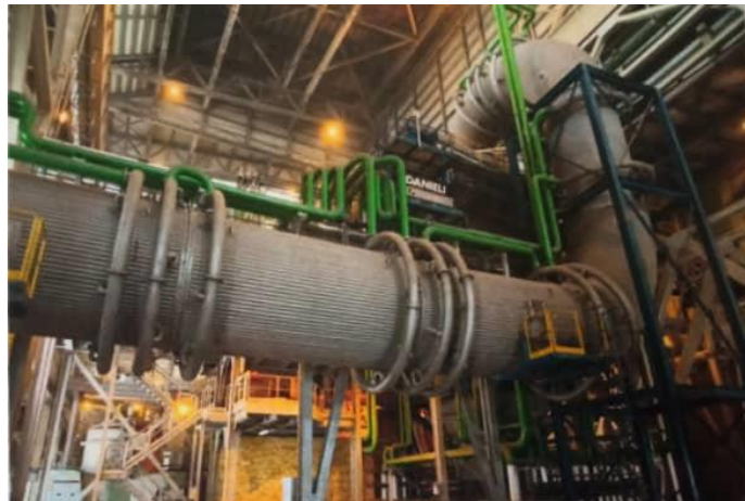
Figure 3 : Conduit refroidi à l'eau. Source : auteur
