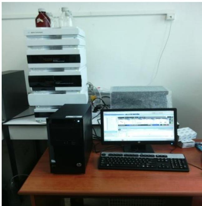
*Figure III.3: HPLC (Agilent 1260 infinity) used in analysis (Laboratoire de Chimie Appliquée, Université 8 Mai 1945, Guelma).*
