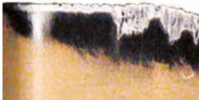
*Figure I. 17 Usure par écaillage[35].*
