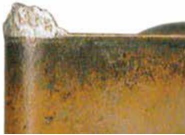
*Figure I. 18 Usure par arête rapportée [35].*
