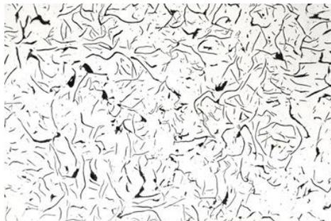
*Figure I. 7 Microstructure de la fonte grise [23].*
