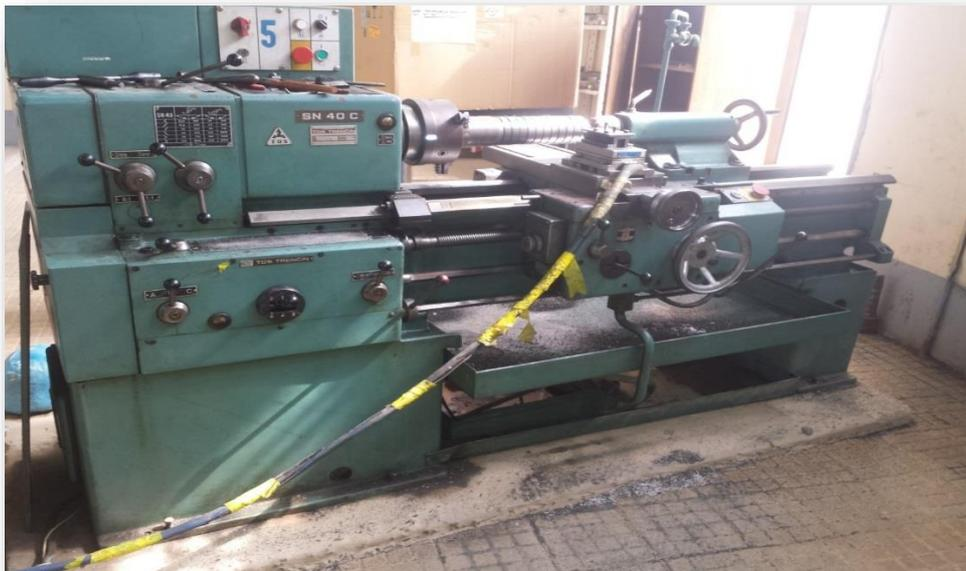
*Figure II. 1* Tour parallèle modèle SN40C
