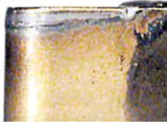
*Figure I. 14 Usure en dépouille [35].*
