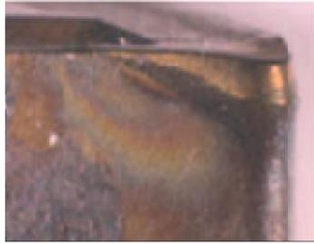
*Figure I. 16 Usure par déformation plastique [37].*
