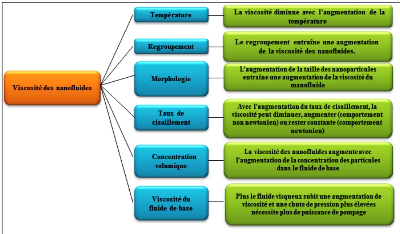
**Figure I.18:** Paramètres affectant la viscosité des nanofluides [72].
