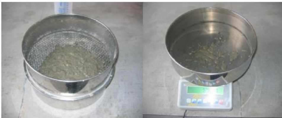
Figure III.8. Essai de la stabilité au tamis.
