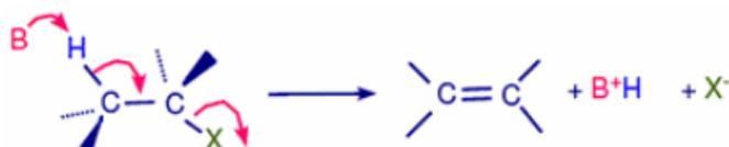
L'attaque de la base et la rupture des liaisons C-X et C-H se font simultanément : la base attaque la liaison C-H qui s'affaiblit, pendant que la liaison C-X se polarise.
