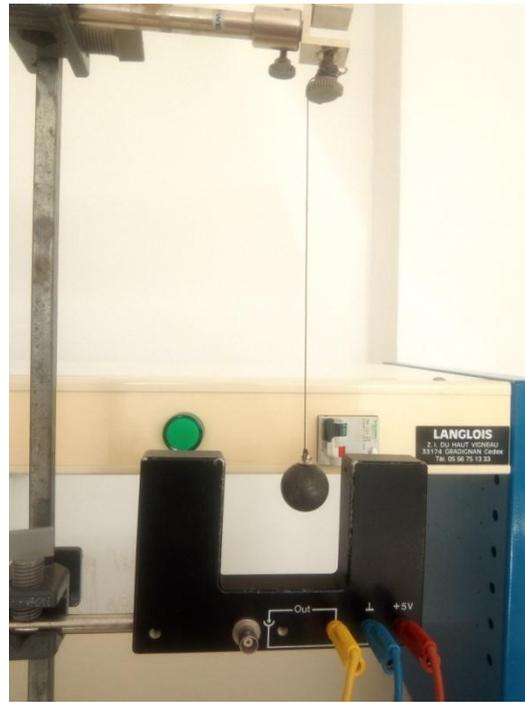
Figure 2 : Photographie du montage de pendule simple
