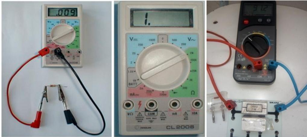
Figure 3 : Photographie du montage de mesure directe d'une résistance  $R$  par le biais d'un multimètre.
