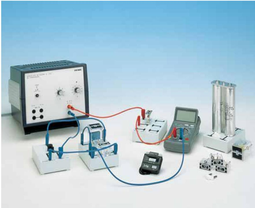
Figure 4 : Photographie du Montage : Charge et décharge d'un condensateur
