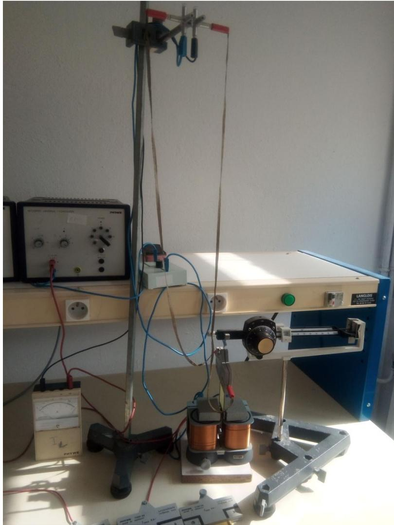
Figure 3 : Photographie de la manipulation de balance de Cotton
