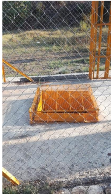
Photo III-3 : Bac d'évaporation classe « A » et Colorado installé à proximité de la retenue du barrage de Bouhamdane (Guelma).
