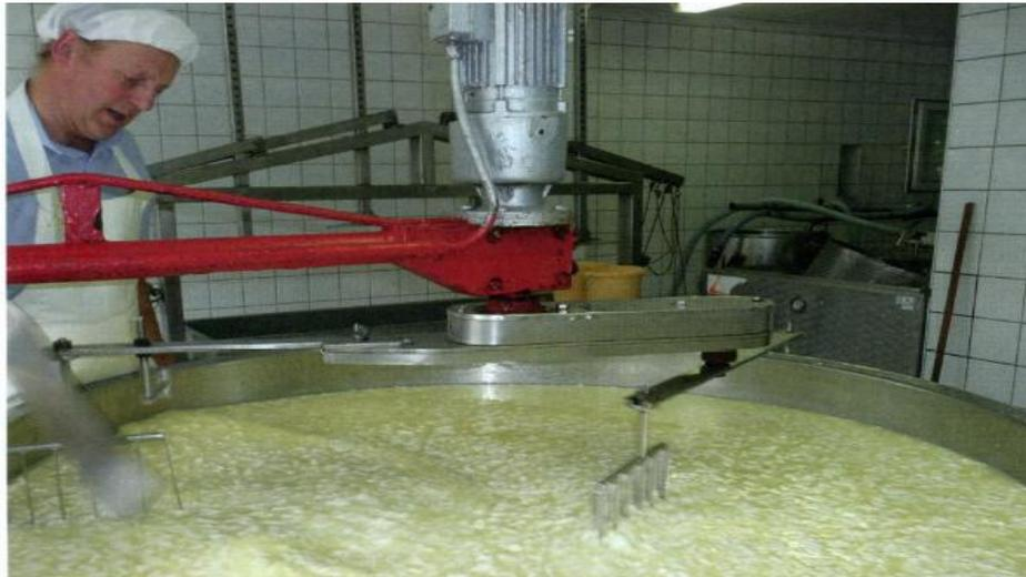
**Figure 14 :** Cuve double paroi (pasteurisation-coagulation –tranchage) [6].
