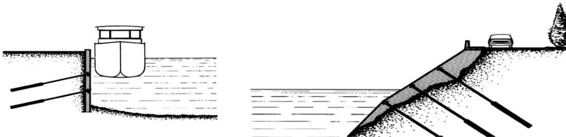
(e) Utilisation des tirants d'ancrage dans les murs de quai (f) Utilisation des tirants d'ancrage dans les murs de soutènement
