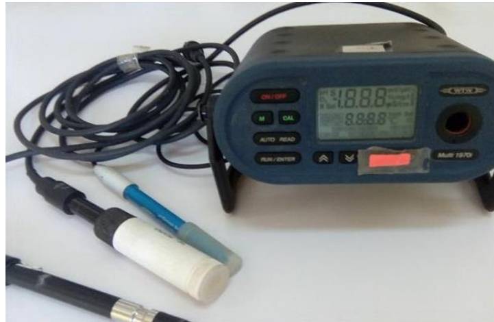
Figure 08. Photo de Multi paramètre de terrain de marque WTW (Multi 1970i).
