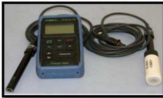
**Figure 05** : Photos de multi paramètre utilisé (WTW Multi 1970i)
