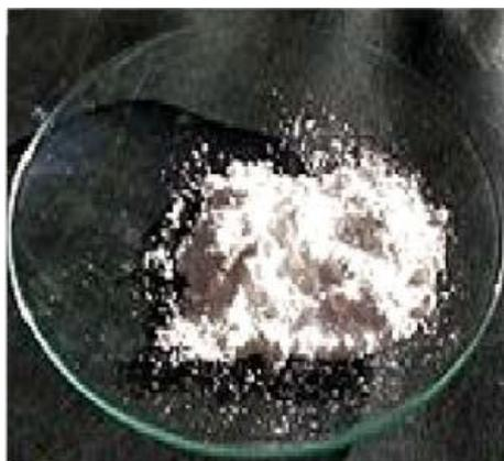
**Figure 10:** Poudre de dioxyde de titane. (Brahmi et al., 2017)
