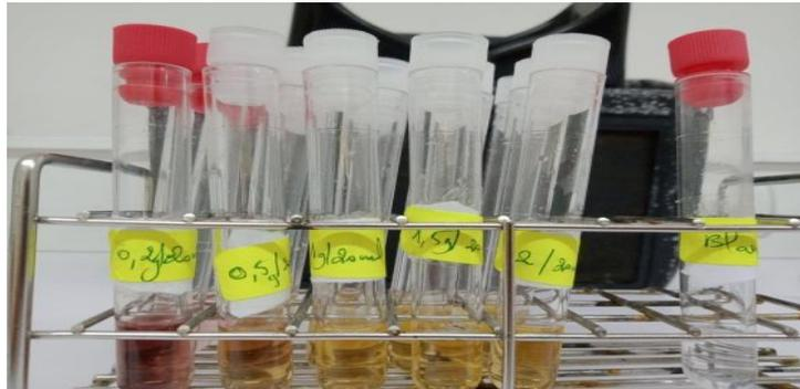
**Figure 11.** Dosage du DPPH (Photo prise au laboratoire)
