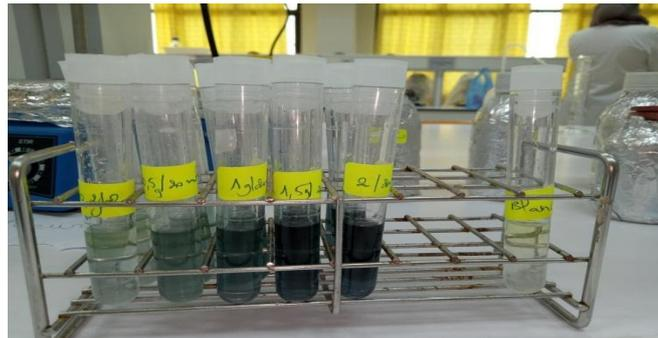
**Figure 9.** Dosage des composés phénoliques totaux. (Photo prise au laboratoire)
