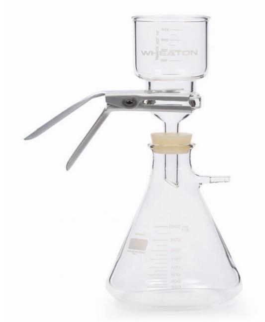
**Figure 11.** Appareil de filtration sous vide.
