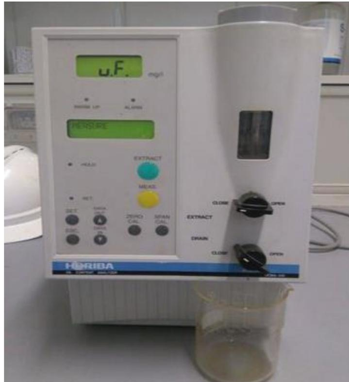
**Figure 12.** Appareil de séparation des hydrocarbures.
