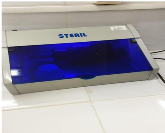
**Figure 6.** Stérilisateur UV des flacons en verre et bouchons en PEHD.
