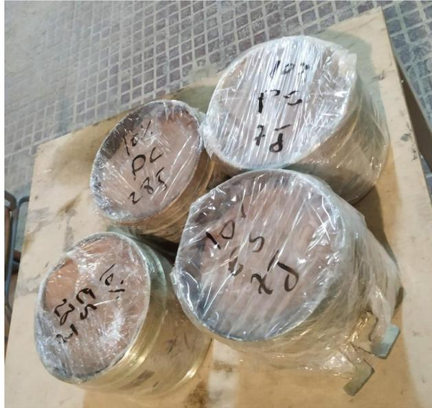
FIG. 109 Confectionnement des éprouvettes pour les tests CBR
