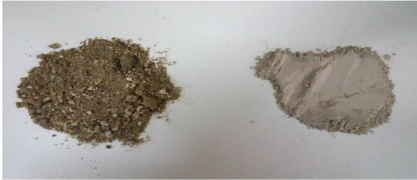
FIG. 136 Le laitier granulé avant et après broyage.
