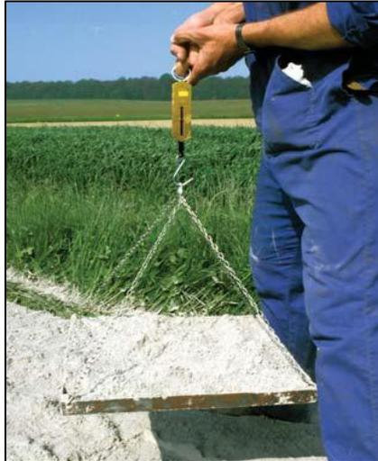
FIG. 64 Contrôle de l'épandage: pesée de l'agent de traitement épandu sur un plateau en aluminium
