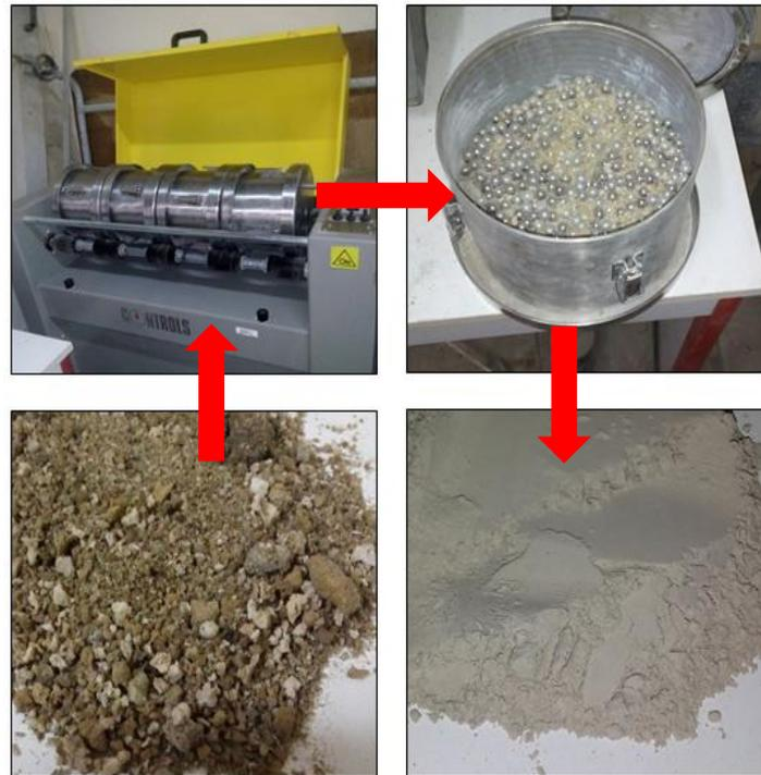
FIG. 96 Broyage du laitier granulé
