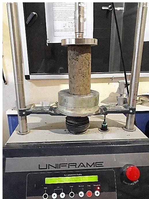
FIG. 108 Ecrasement des éprouvettes
