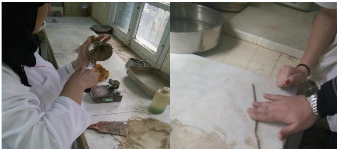
FIG. 87 Déroulement des essais de consistance
