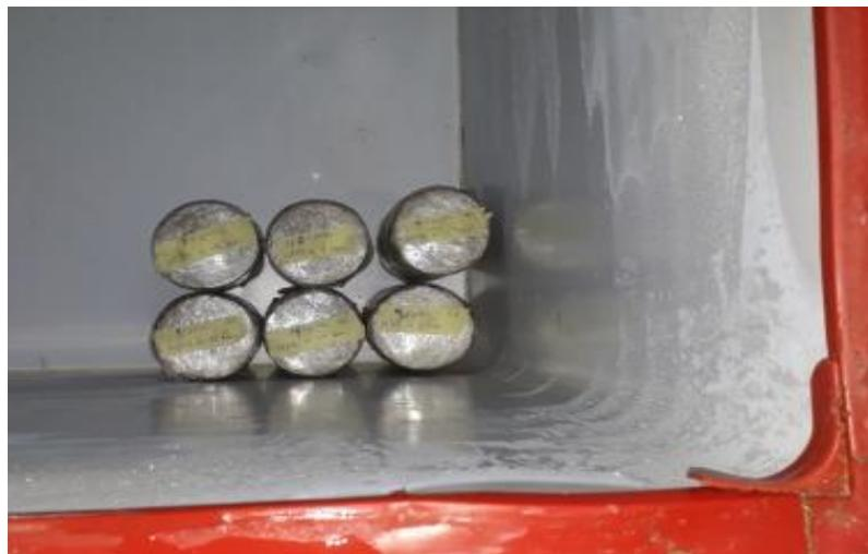
FIG. 139 Arrangement des éprouvettes dans le congélateur
