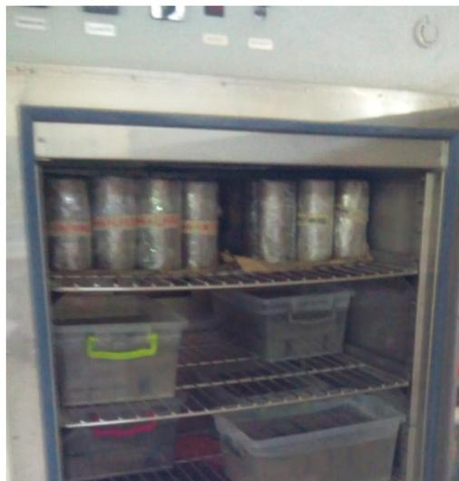
FIG. 140 Arrangement des éprouvettes dans la chambre thermique
