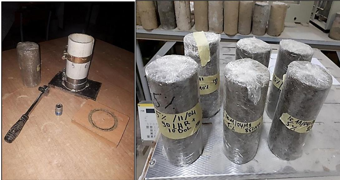
FIG. 107 Photos du moule et de quelques éprouvettes confectionnées
