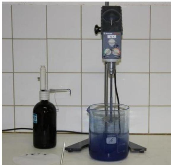
FIG. 72 Dispositif mesurant la VBS
