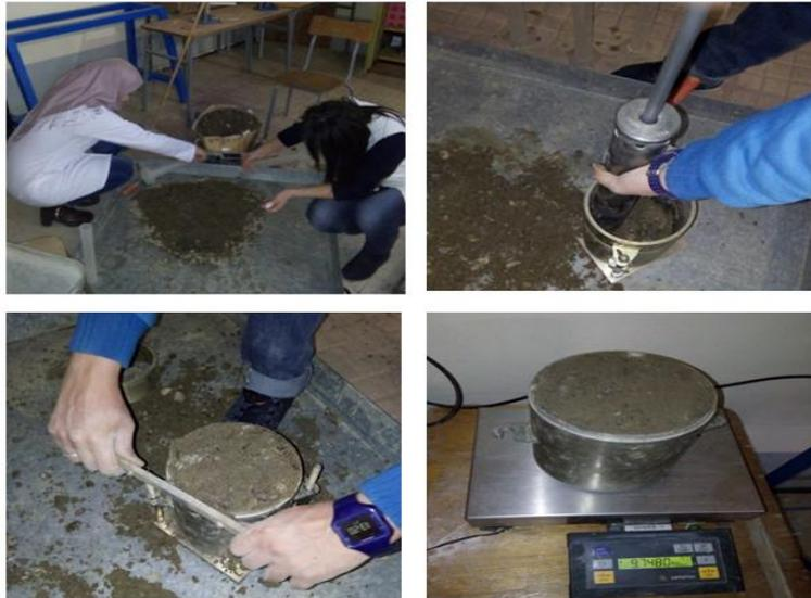
FIG. 105 Etape de l'essai Proctor
