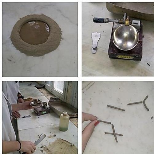
FIG. 106 Détermination des limites de consistance après traitement
