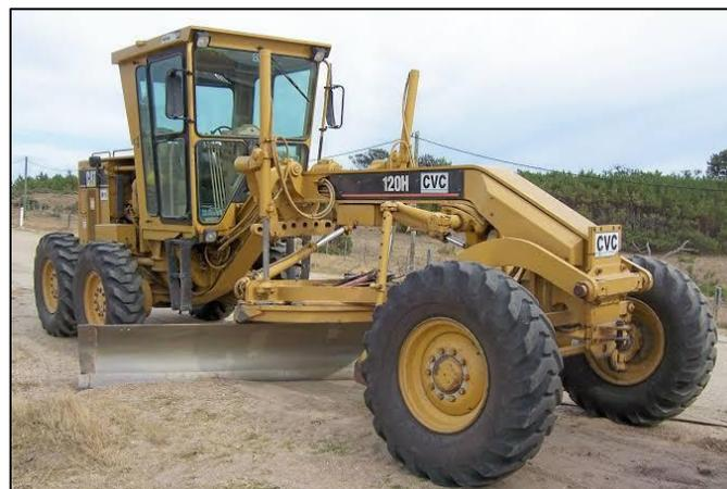
FIG. 67 Réglage d'une couche compactée avec niveleuse
