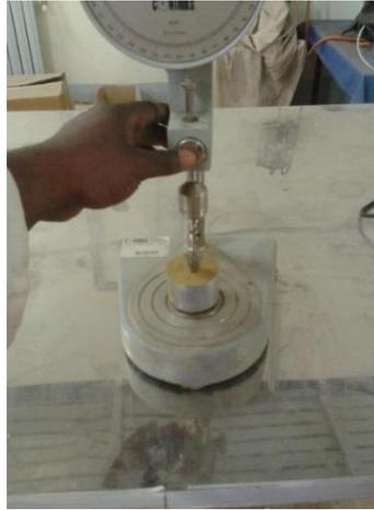
FIG. 71 Détermination de  $W_L$  par la méthode de cône de pénétration
