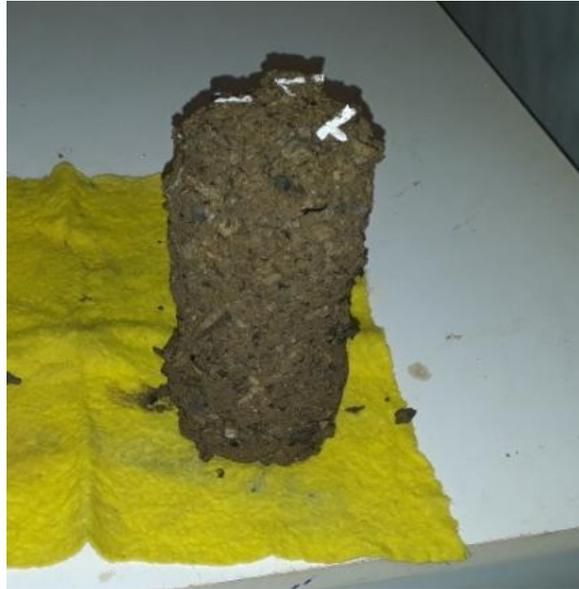
FIG. 144 Eprouvette détruite
