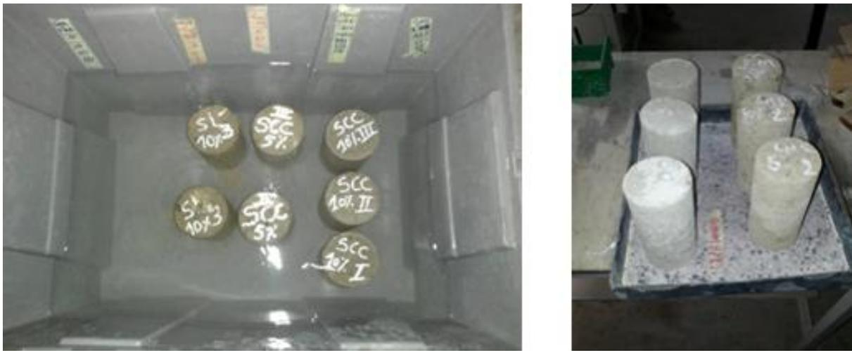
FIG. 141 Séchage-humidification des éprouvettes
