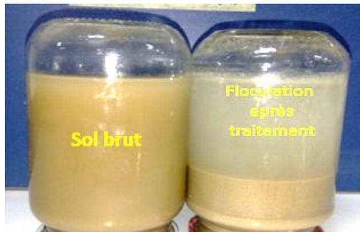
FIG. 29 Floculation des particules argileuses après traitement
