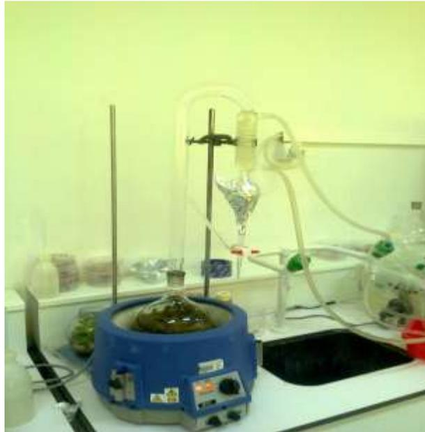
**Figure 03 : Extraction des HEs par hydrodistillateur de type Clevenger**
