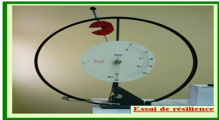
**Figure III.4:** Machine d'essai de choc Charpy.
