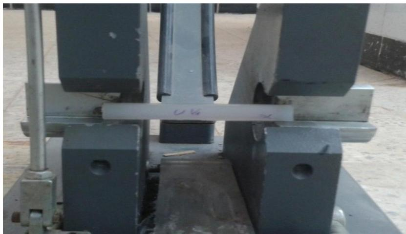
**Figure IV.10:** Eprouvette sur la machine de résilience.
