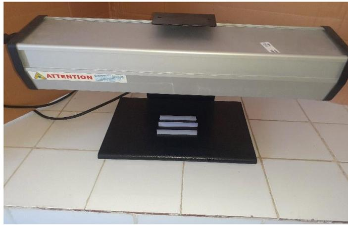
**Figure IV.3:** Les éprouvettes au cours de vieillissement par UV.
