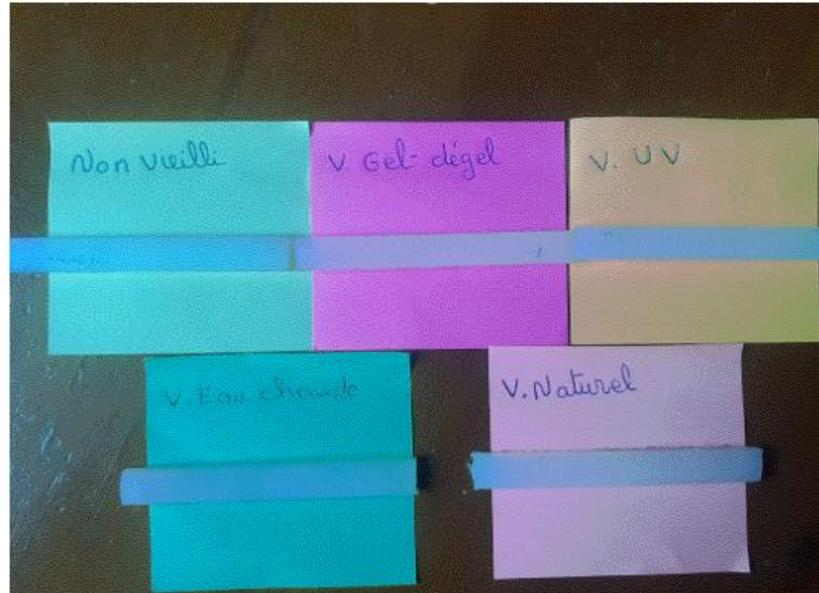
Figure IV.2: Les éprouvettes de PA 6-6 utilisées.
