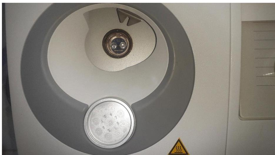
**Figure IV.18:** Les deux creusets placés dans l'appareille de DSC.
