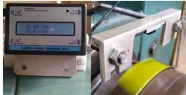
**Figure II.3.** Capteur de vitesse de rotation de la broche
