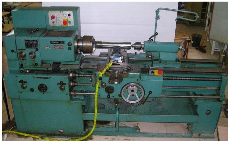
**Figure II.1.** Tour à charioter et à fileter modèle SN40C
