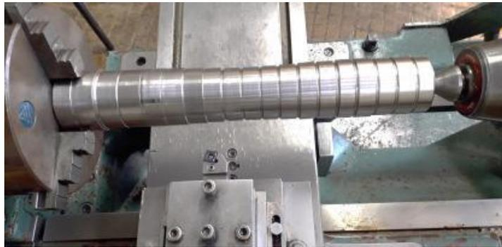
**Figure II.4.** Éprouvette utilisée en essais (Inconel 718)
