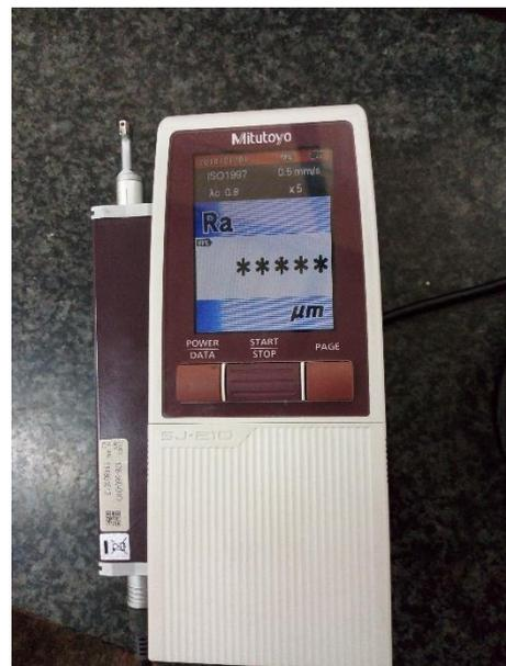
Figure II.7. Rugosimètre 2D modèle SurfTest SJ- 210 de Mitutoyo avec logiciel d'exécution.
