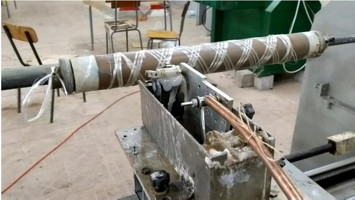
Figure 2.3 : Mandrin et bain de résine de la machine d'enroulement filamentaire.
