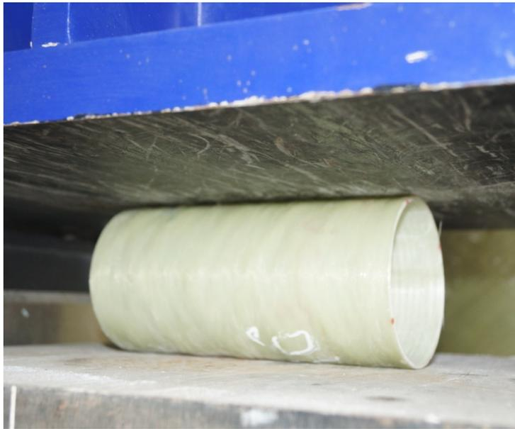
**Figure 2.8** : Test de compression radiale d'un tube verre/époxy.
