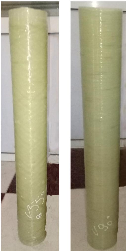
**Figure 2.1** : Tubes en matériau composite Verre/époxy :a) Angle d'enroulement  $(90)_4$
