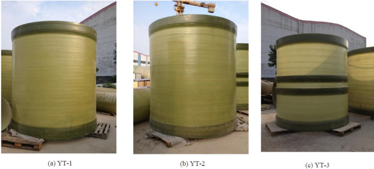
Figure 1. 14 : Spécimens de chemises de cheminée cylindriques en PRFV : (a) YT-1, (b) YT-2, (c) YT-3.
