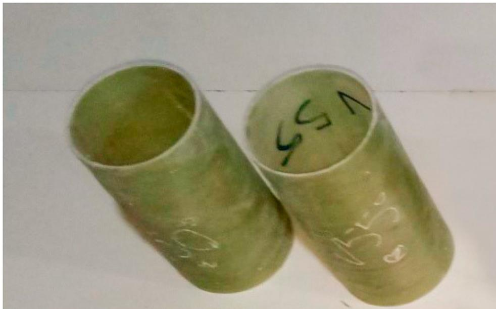
**Figure 2.6** : Eprouvettes de  $(90)_4$  et  $(90/\pm 55)_s$  découpées selon les normes ASTM D2412.
