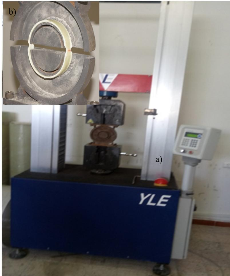
**Figure 2.10** : a) Machine de traction universelle YLE YL25.
