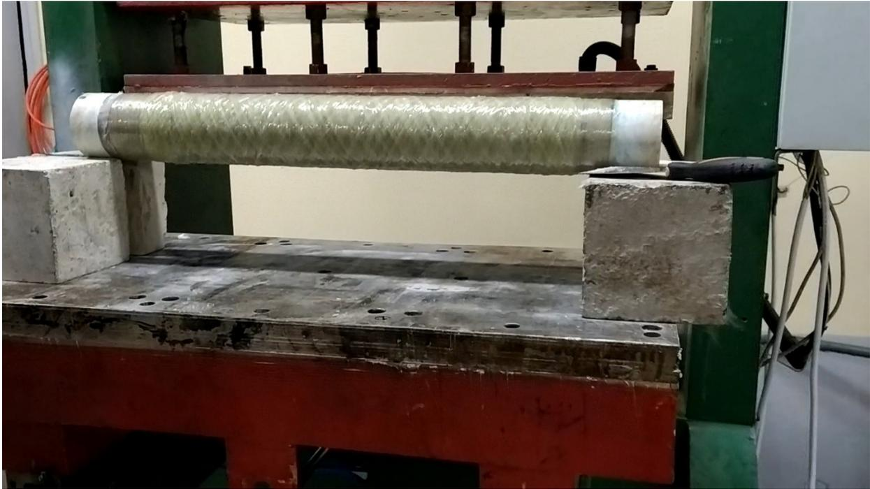
**Figure 2.2 :** Polymérisation de tube sur une plaque chauffante.
